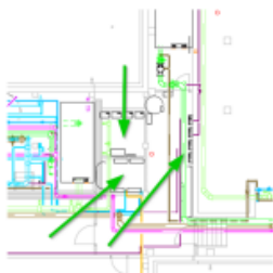
Klor-syrerum, analysebord, hoveddeltavle og kemistyringer placeres centralt i teknikkælderen.
